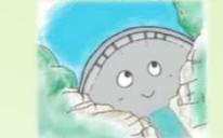
弓形のアーチ構造によって両側の山に突っ張るようにして水圧に耐えるダムです。両側の山に弱い層がないことを確認し、足下の地質が非常に固い場所に建設されます。
