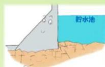
ダム自体の重さや固さ、ダムの足下の地質の固さで水圧に耐えるダムです。足下の地質が固い場所に建設され、それらの固さなどによって、ダムが太ったり・スリムになったりします。
