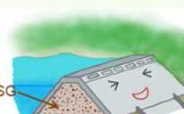
ダム近くの河原で採取した砂や礫をセメントで混ぜ固めたダムで、様々な地質で経済的に建設できる新しいダムタイプです。足元の地質が比較的軟らかくても経済的に建設が可能であるため、最近増加しています。
